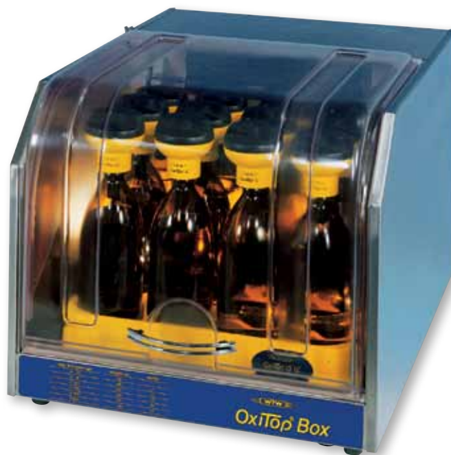
Przykład zastosowania: OxiTop® Box z zestawem OxiTop® Control 12
